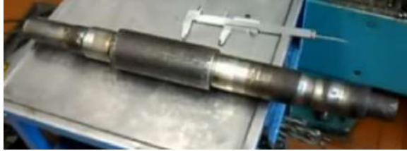
Рис. 3. Дефекти валу насосу
