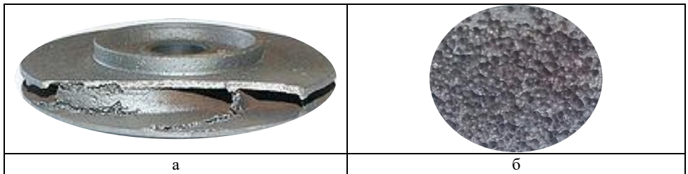
Рис. 4. Сліди кавітаційного зносу робочого колеса насосу
